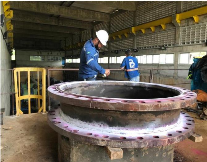
O ensaio por líquido penetrante é considerado um dos melhores métodos de teste para detecção de descontinuidades superficiais de materiais isentos de porosidade tais como: Metais ferrosos e não ferrosos, alumínio, ligas metálicas, cerâmicas, vidros, certos tipos de plástico ou materiais sintéticos.
