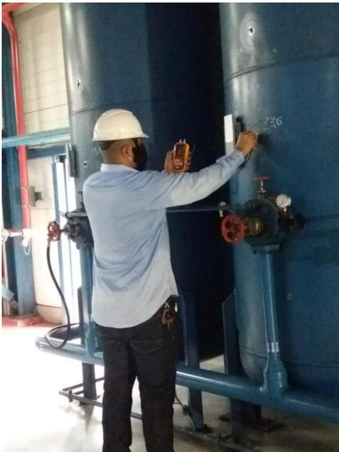
Utiliza-se ultrassom também para medir espessura e determinar corrosão com extrema facilidade e precisão.
