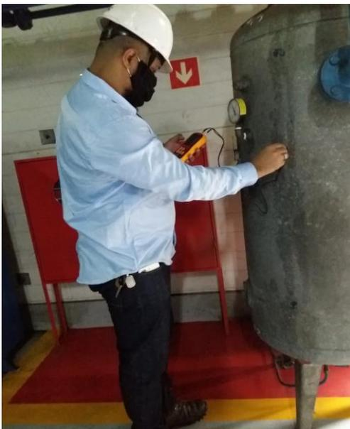
Modernamente o ultrassom é utilizado na manutenção industrial, na detecção preventiva de vazamentos de líquidos ou gases, falhas operacionais em sistemas elétricos (efeito corona), vibrações em mancais e rolamentos, etc.
