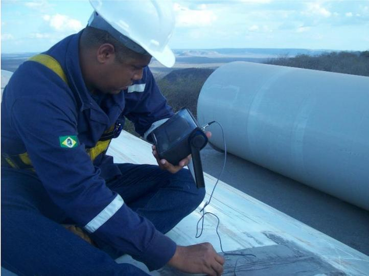
Detecta descontinuidades internas em materiais, baseando-se no fenômeno de reflexão de ondas acústicas quando encontram obstáculos à sua propagação, dentro do material.
